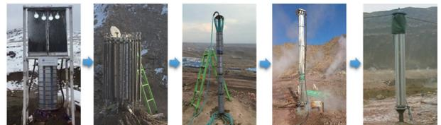
图 5 煤田火区分布式热提取发电装置研发优化对比
