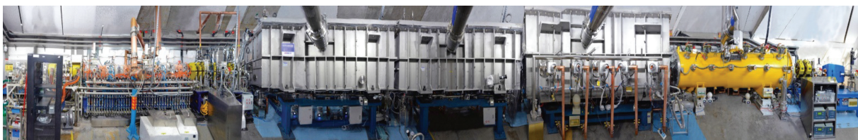
图 3 国际首台 ADS 超导直线加速器前端示范样机
