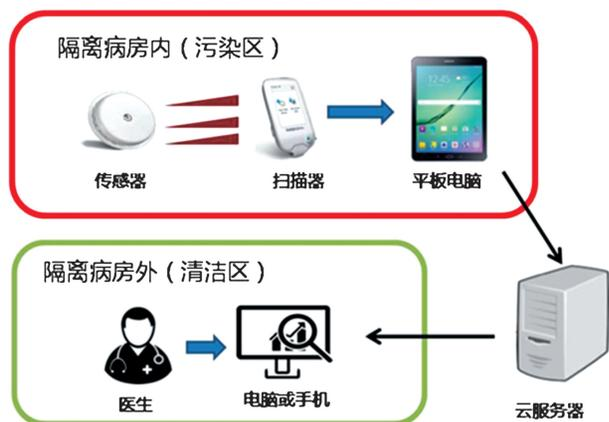
图1 基于扫描式血糖监测和云平台联网系统的血糖监测及管理新模式
