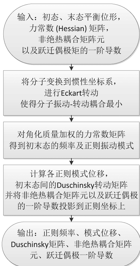
图2 电子-振动耦合计算程序流程图
