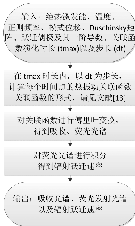
图3 吸收光谱、荧光发射光谱以及其辐射跃迁速率计算程序流程图
